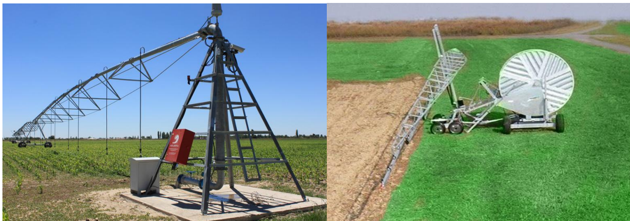
Рис. Дождевальные установки Mini-Pivot и IRRILAND «Raptor»
